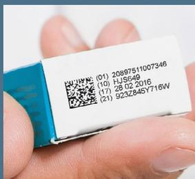
Las impresoras de inyección de tinta continua (CIJ) constituyen una solución flexible, ya que permiten imprimir hasta 5 líneas de texto, así como códigos de barras en 2D y lineales en una amplia gama de tipos de envasado, mientras que las impresoras por transferencia térmica (TTO) resultan ideales para imprimir imágenes de alta resolución en etiquetas y film de envasado flexible.
